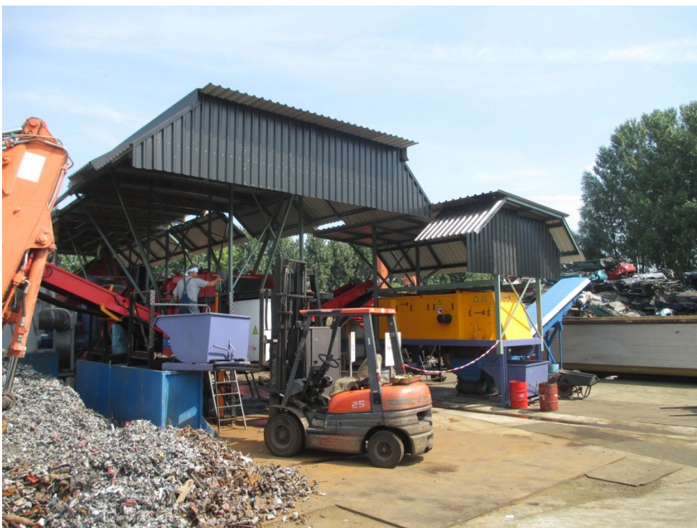
Figuur 4.2.5: metaalscheiders (links magneetscheider/ rechts alu/ koper scheider)
