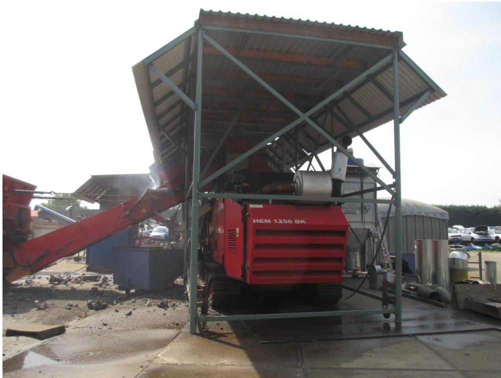
Figuur 4.2.2: shredder (overkapt) met luchtaanzuig en uitlaat. In dit onderzoek wordt deze zijde van de shredder als achterzijde bestempeld.
