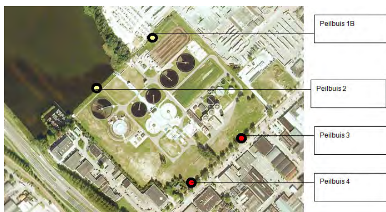
Afbeelding 2.6 ligging peilbuizen stroomopwaarts (rood, nr 3 en 4) en -afwaarts (geel, nr 1 en 2)
