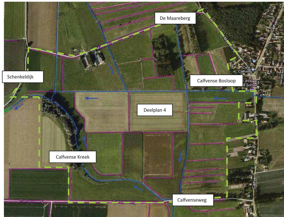
Figuur 6 Overzicht A en B watergangen deelplan 4 (bron: waterschap Brabantse Delta) A-waterloop = Blauw, B-waterloop = paars, Plangrens = groene stippellijn
