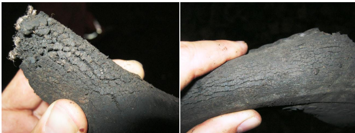
Figuur 2: close-up van bandenshreds met sporen van verval
