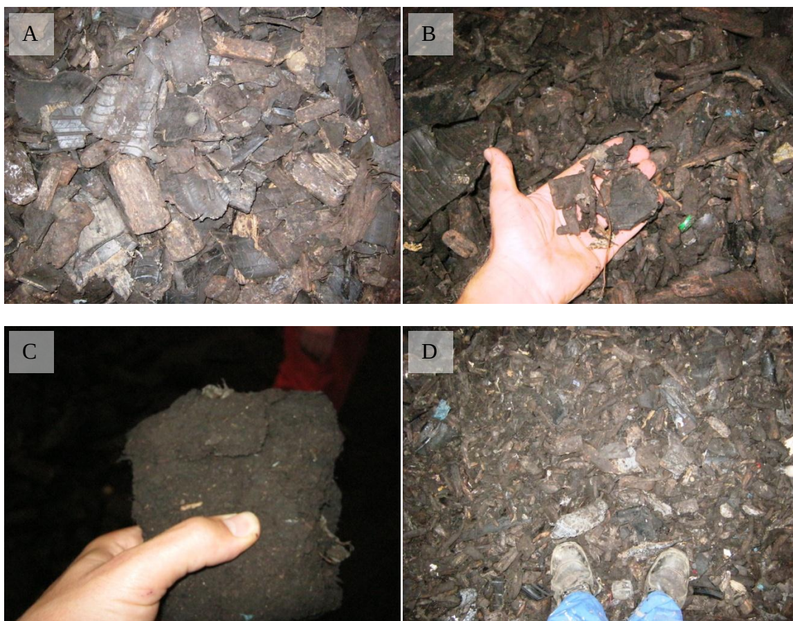
Figuur 1: Impressies van de zeefoverloop (>12mm)
