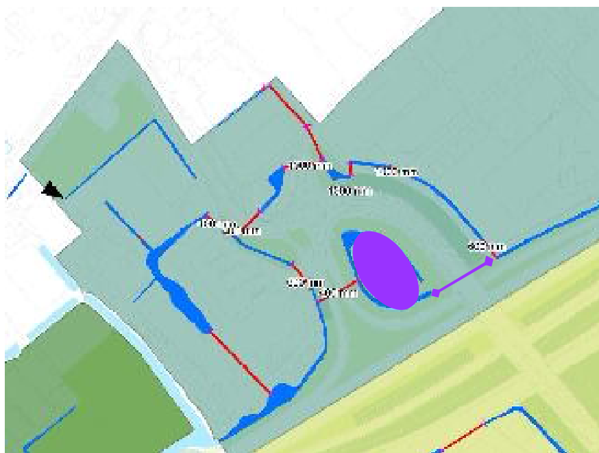
Figuur 7.13 Locatie retentievijver in klaverblad van de A44 en extra duiker ernaartoe.
