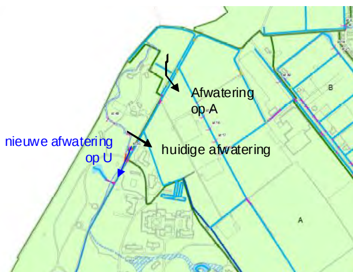
Figuur 11 Afwatering origineel peilvak U
