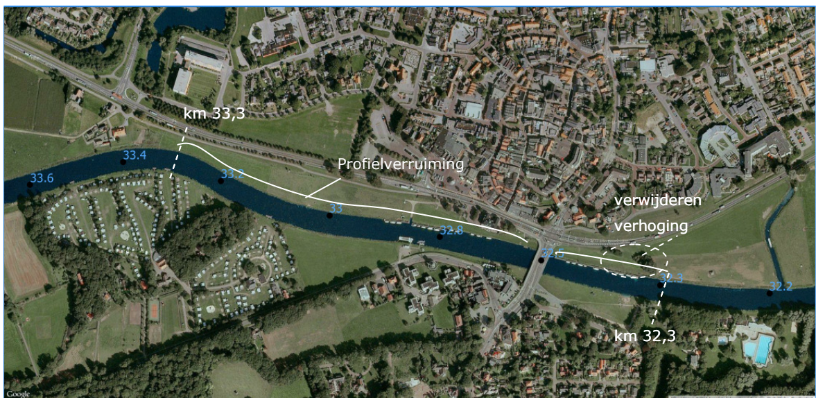
Figuur 3-2 Traject met maximum (boven) en minimum (onder) profielverruiming bij Ommen
