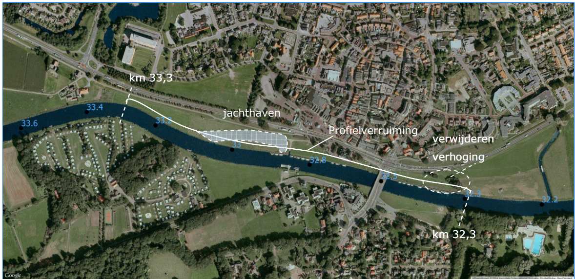
Figuur 4-2 Schematische weergave maatregelen HKV 2009 en aanleg jachthaven.
