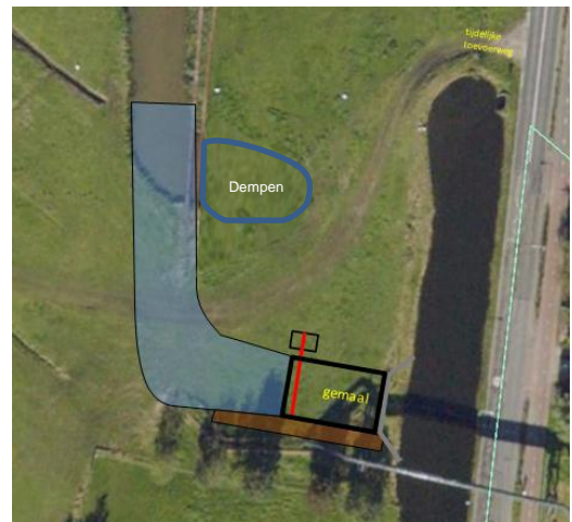
Afbeelding 12: Aansluiting watergang A op gemaal
