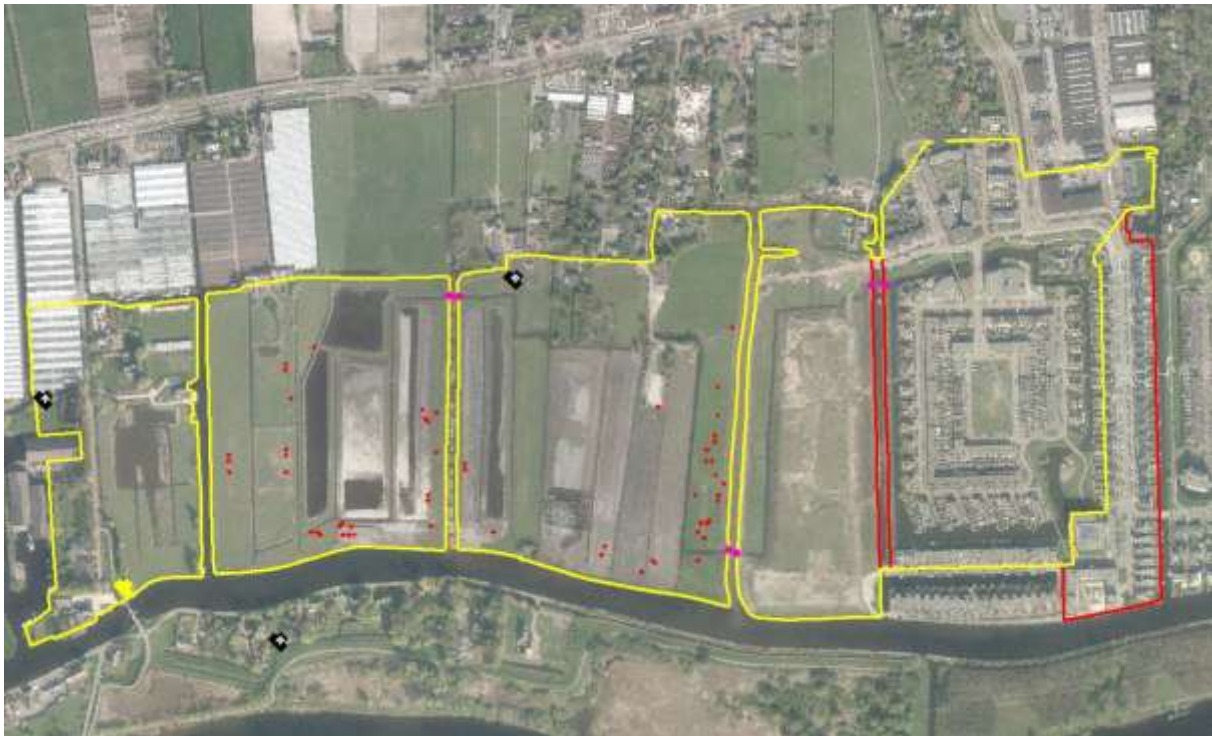
Figuur 7. Resterende knelpunten voor de wateropgave na ophogen percelen van baggerdepot's, samenvoeging van Starrenburg III aan vak 1.2 en toevoeging van Knippolder 1.1.
