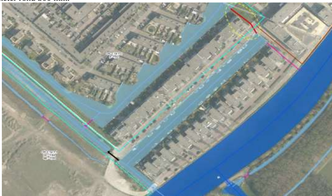
Figuur 4 Vervangende inlaat bij Hofvliet (maatregel 4) voor betere doorstroming van het watersysteem.
