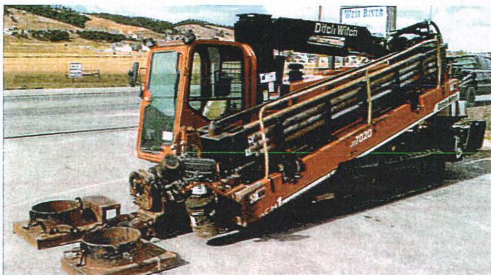
Afbeelding: 50 tons boor-rig Van Vulpen
