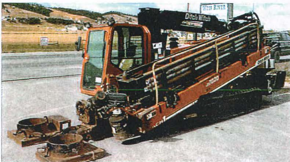
Afbeelding: 50 tons boor-rig Van Vulpen
