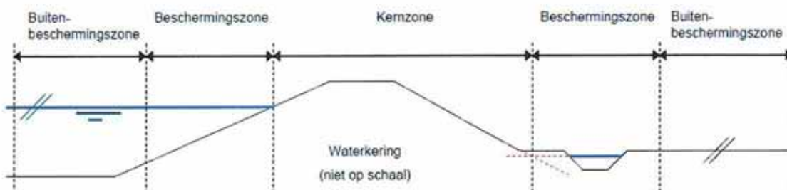
Figuur 6. het principe van zonering van een waterkering
