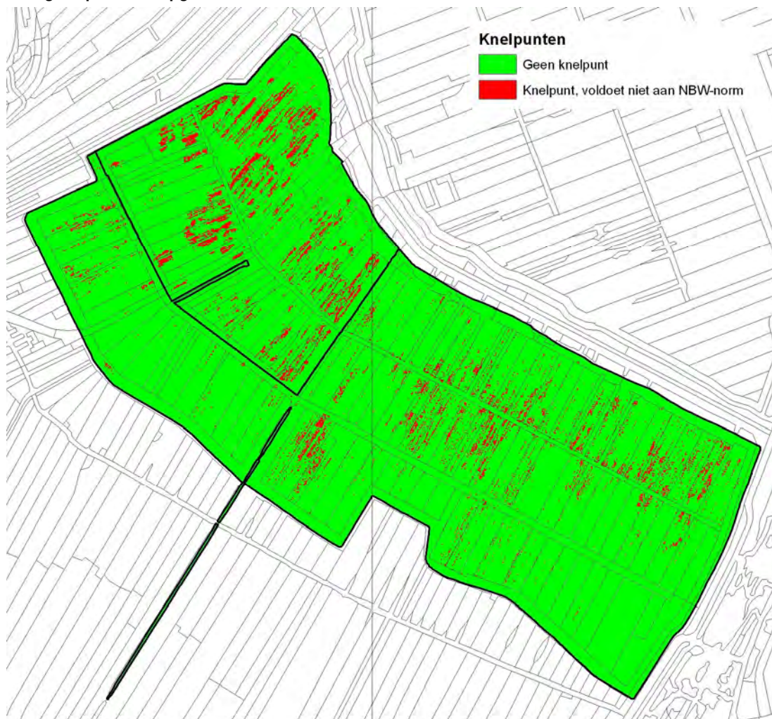
Figuur 6.9 Knelpunten waterberging Drooggemaakte polder aan de westzijde te Aarlanderveen bij huidige capaciteit hulpgemalen
