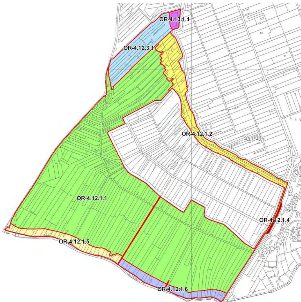
Figuur 7.5 Peilvakken variant B Zuid- en Noordeinderpolder en Drooggemaakte Hoef- en Schoutenpolder: peilvakken op basis van optimale drooglegging
