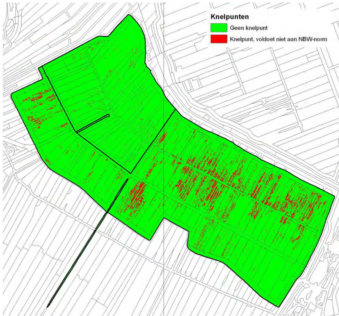
Figuur 6.10 Knelpunten waterberging Drooggemaakte polder aan de westzijde te Aarlanderveen bij volwaardige capaciteit hulpgemaal OR-4.11.2.1 en huidige capaciteit andere hulpgemalen
