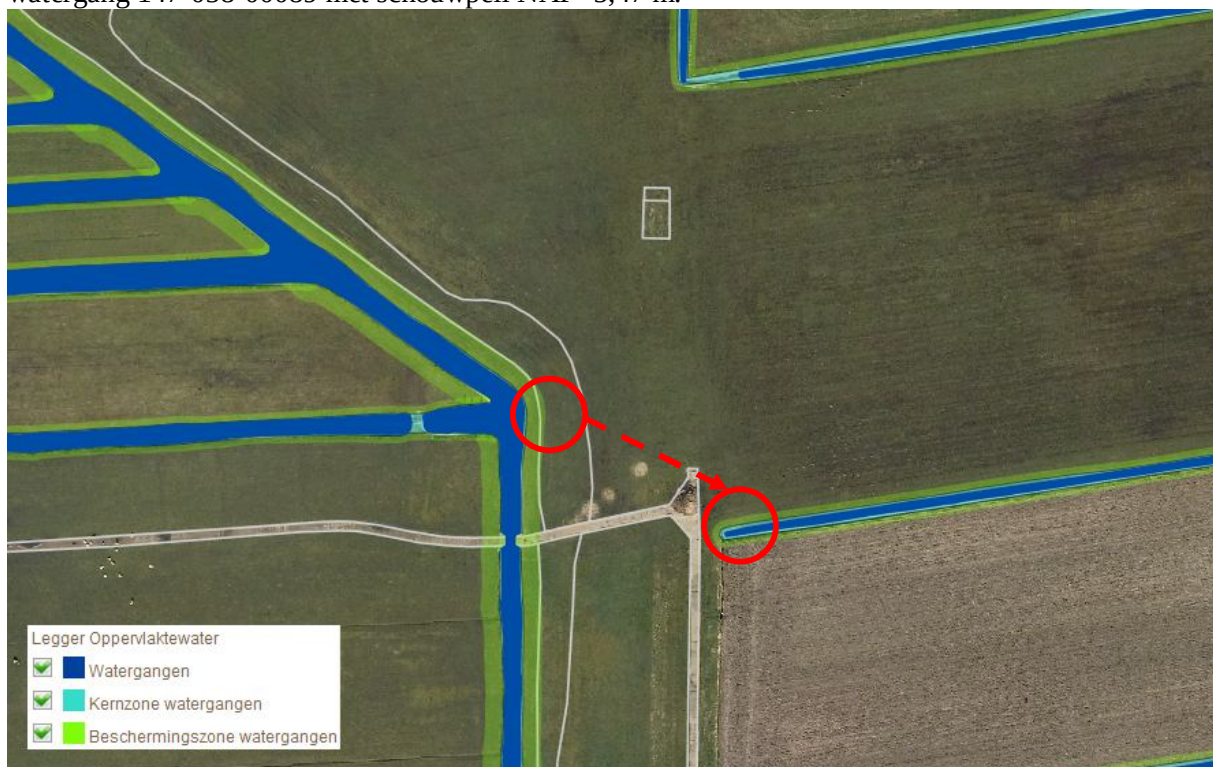
Figuur 3.1: Ligging te plaatsen stuw 8.07: linksboven: instroombak, rechtsonder: uitstroombak
