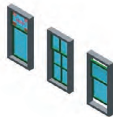
Oorspronkelijke kozijnen uit de bouwperiode van voor 1900
