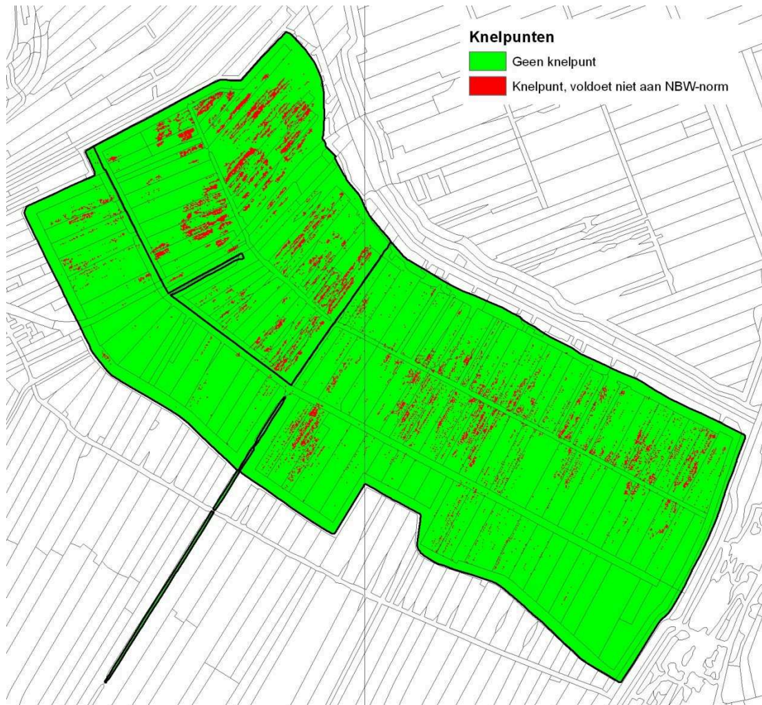
Figuur 6.9 Knelpunten waterberging Drooggemaakte polder aan de westzijde te Aarlanderveen bij huidige capaciteit hulpgemalen
