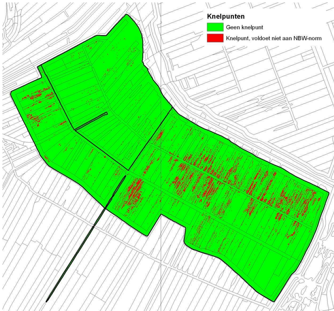
Figuur 6.10 Knelpunten waterberging Drooggemaakte polder aan de westzijde te Aarlanderveen bij volwaardige capaciteit hulpemaal OR-4.11.2.1 en huidige capaciteit andere hulpgemalen
