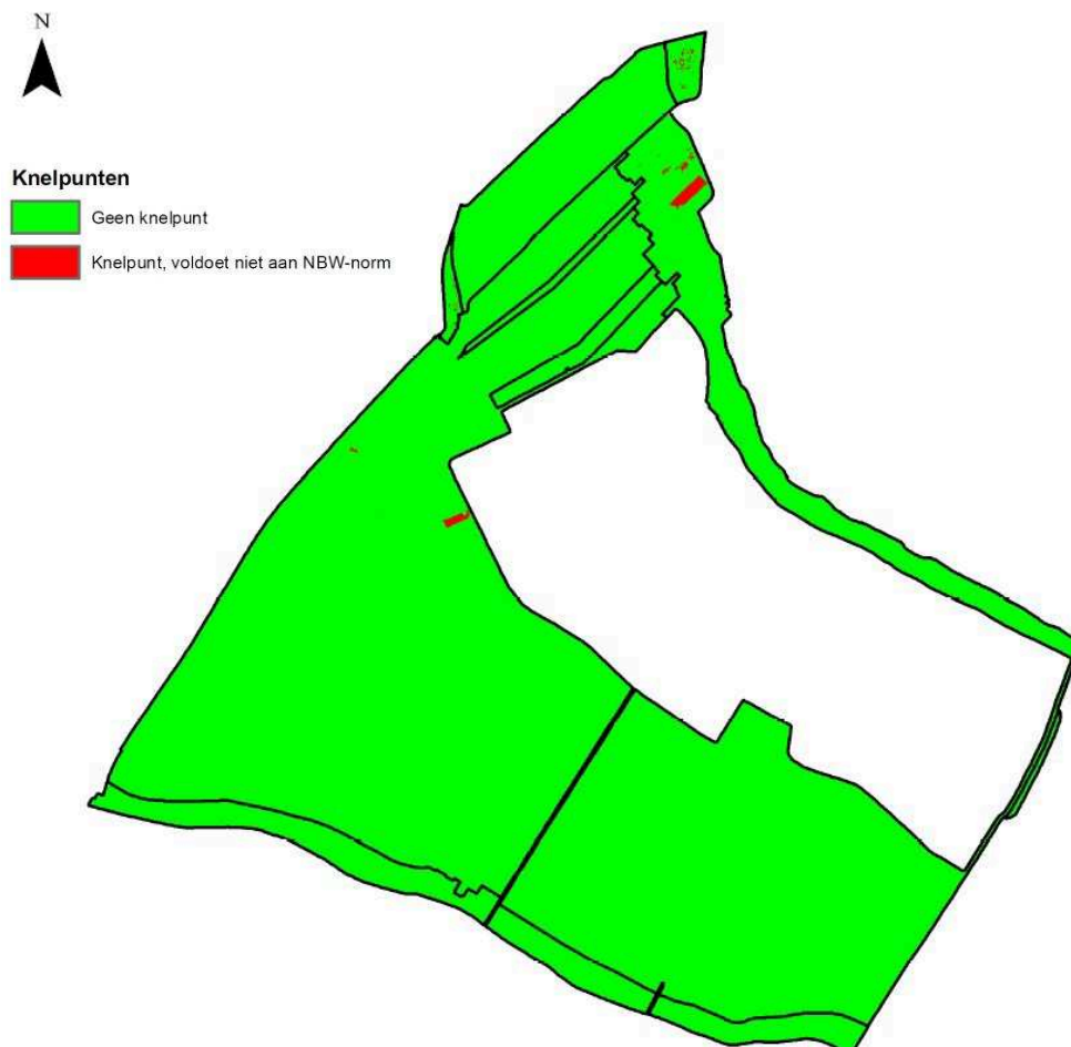
Figuur 7.6 Knelpunten waterberging variant B Zuid- en Noordeinderpolder: peilvakken op basis van optimale drooglegging
