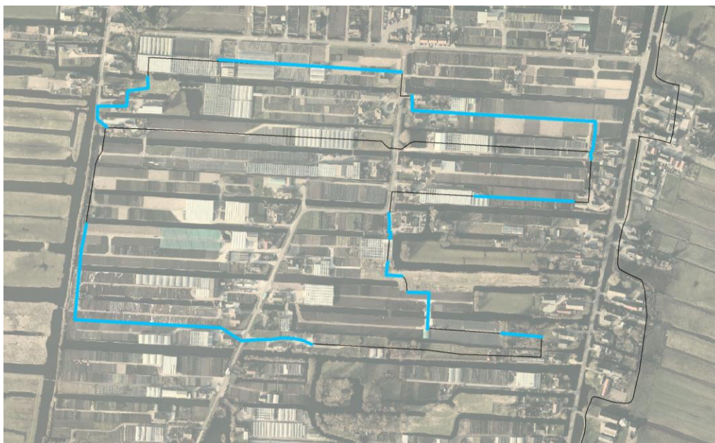
Figuur 4.13: Delen van de peilvakscheiding van Berkenbroek noord- en zuid die lager liggen dan de berekende peilstijging (T50) in de Gouwepolder
