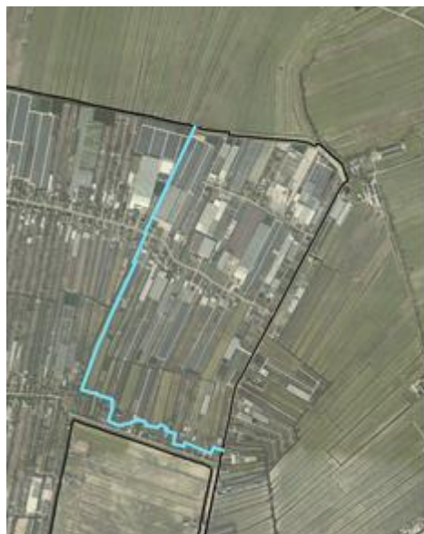
Figuur 6.8 Te laag liggende peilvakscheiding van Spoelwijk (blauwe lijn)
