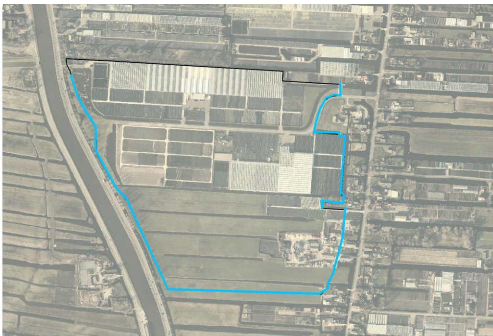
Figuur 4..14: Delen van de peilvakscheiding van Randenburg-Gouwedreef die lager liggen dan de berekende peilstijging (T50) in de Gouwepolder
