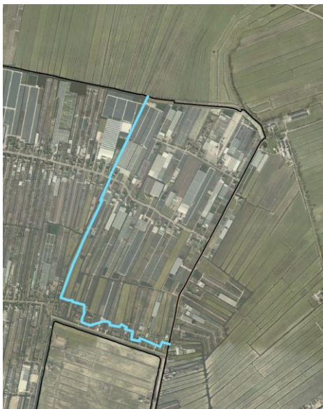
Figuur 4.11: Delen van de peilvakscheiding van Spoelwijk die lager liggen dan de berekende peilstijging (T50) in de Gouwepolder
