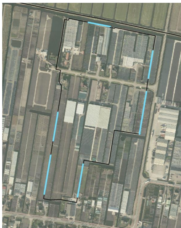
Figuur 4..8: Delen van de peilvakscheiding van Koetsveld die lager liggen dan de berekende peilstijging (T50) in de Gouwepolder
