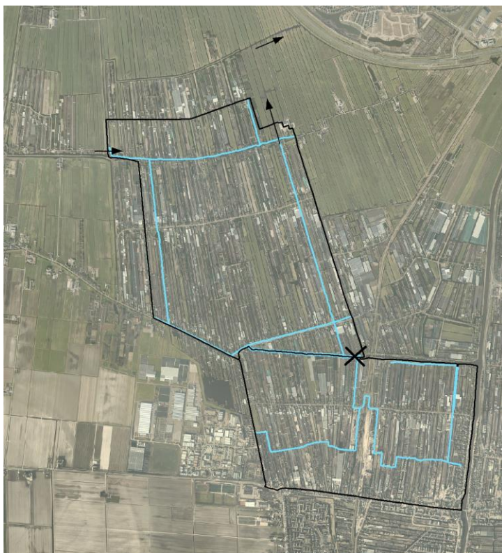
Figuur 4..3 Afwatering Rietveldsepolder omdraaien naar polder het Zaanse Rietveld (variant 3)
