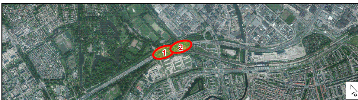
Figuur 2.2 Nieuw goederenopstelspoor (1) en aantakspoor (2) in Schiedam
