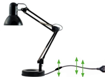
De lamp is aangesloten maar brandt niet: er is een elektrisch veld
