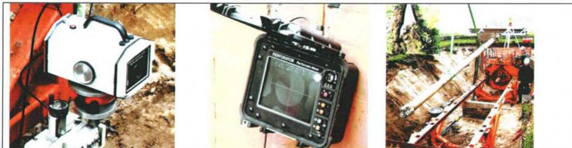
Figuur 4: Foto van camera, monitor en boorkop welke gebruikt worden om de OFT te sturen
