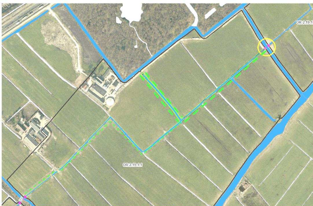
Figuur 4 Maatregelen voor de polder Zuidwijk: verbreding van de waterloop (1 en 2 m) en verruimen van de sifon (cirkel)
