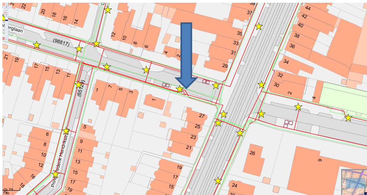
Tekening 1 Kabels en Leidingen vanuit GIS Web
