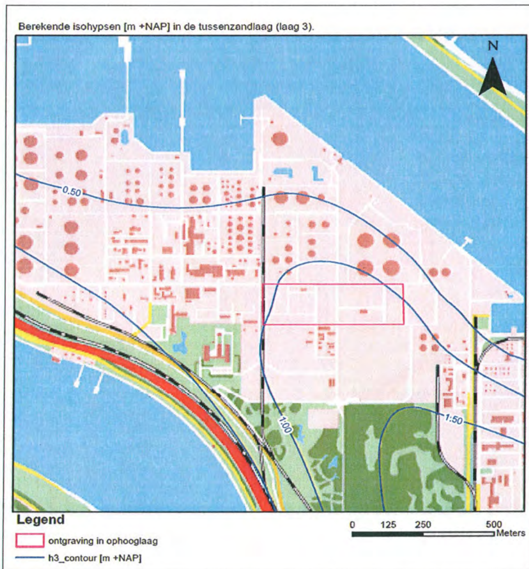
Figuur 3.2. Nieuwbouwproject Orange: berekende isohypsen in de tussenzandlaag (L3) in de situatie met bemaling van een vak van 50 m x 150 m in de ophooglaag (L1) met een debiet van circa 10 m 3 /uur.
