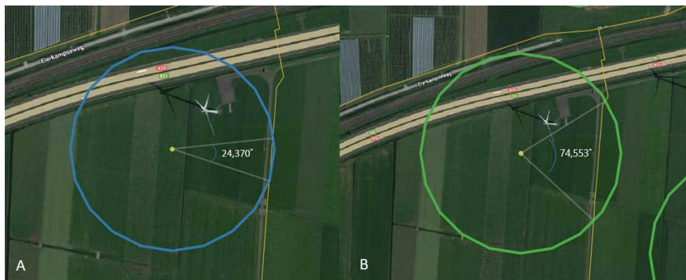
Afbeelding 5.3 Hoek van kruisen effectafstand tot de buisleiding voor de ondergrens (links, effectafstand van 154,97 m) en de bovengrens (rechts, effectafstand van 193,97 m)
