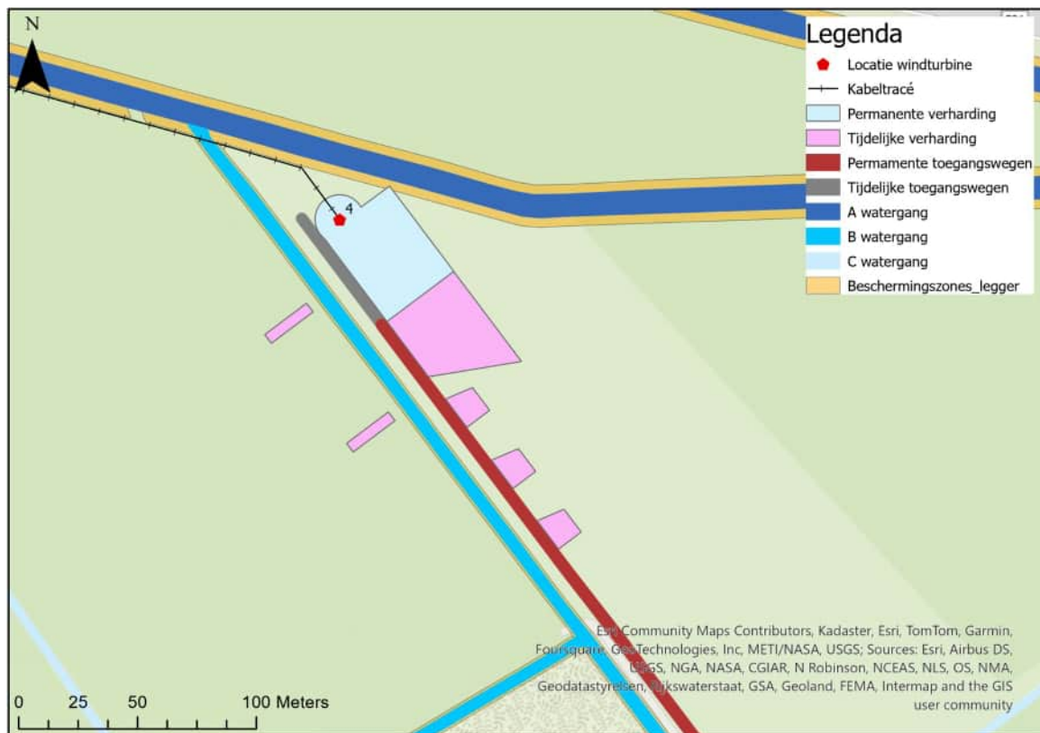
Afbeelding IV.1 Close-up locatie turbine 4
