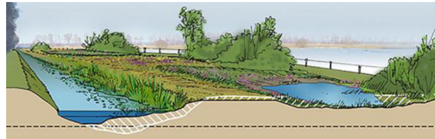
We benutten het lagergelegen nat gebied als retentie/overloop Gemert-Noord
