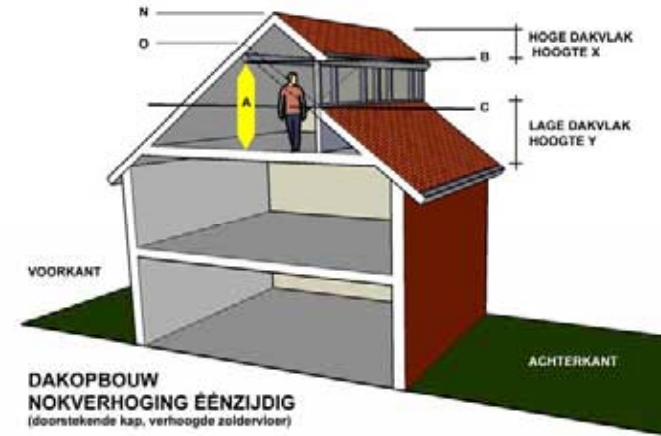
Doorsnede woning met enkelzijdige nokverhoging gericht naar de achterkant.. De woning heeft een verhoogde zoldervloer, c.q. een doorstekende kap.
