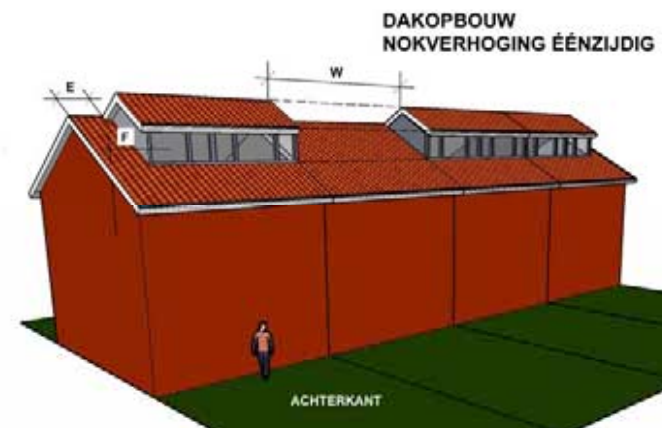
Woningblok met 4 woningen. De dakopbouw op de eindwoning loopt niet door tot de eindgevel, maar wordt eerder beëindigd.
