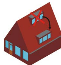
geen dakkapel ter hoogte van vliering, maar onder in het dakvlak situeren
