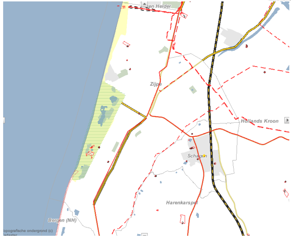
Figuur 4.5: Ligging gasleiding (rode onderbroken streep) en transportroutes (rode streep). (Bron: risicokaart.nl)
