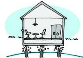
Grondwaterpeil te laag: paalrot
