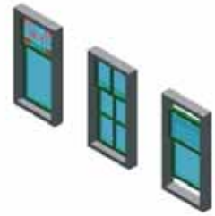
Oorspronkelijke kozijnen uit de bouwperiode van voor 1900
