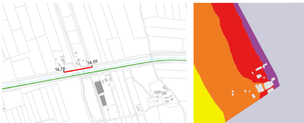
Geluidsscherm langs de A13 (noorden wijst naar links) en niet meer actuele geluidsbelasting volgens de geluidsbelastingkaart, waarin dit geluidsscherm niet is meegenomen in de berekening.
