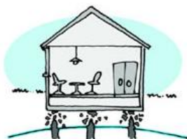
Grondwaterpeil te laag: paalrot
