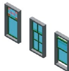
Oorspronkelijke kozijnen uit de bouwperiode van voor 1900
