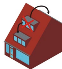
Bij een asymmetrisch dak de dakkapel laag of op het kortste dakvlak plaatsen
