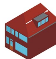
Bij schilddaken de kleinste afstand hanteren voor de plaatsing in het dakvlak
