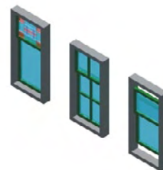
Oorspronkelijke kozijnen uit de bouwperiode van voor 1900
