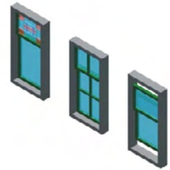
Oorspronkelijke kozijnen uit de bouwperiode van voor 1900
