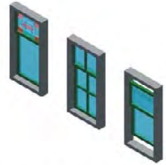
Oorspronkelijke kozijnen uit de bouwperiode van voor 1900
