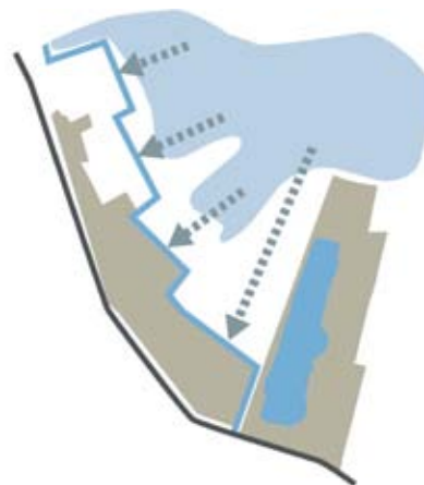
Aanleg kwelsloot ter bescherming van bestaande bebouwing tegen hoge grondwaterstanden (als gevolg van aanleg meer)
