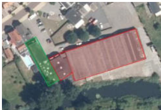
Figuur 23: Te slopen bedrijfshallen, te behouden kantoor
