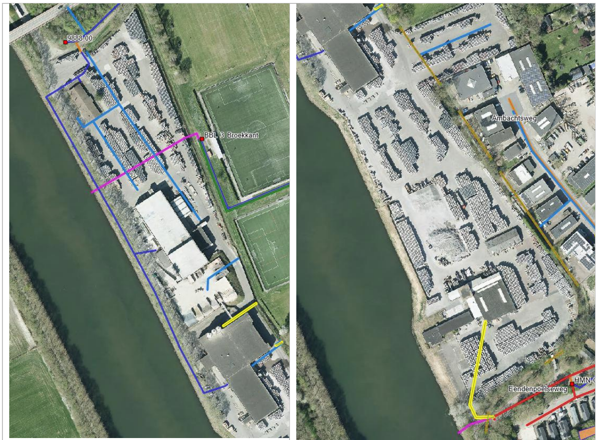
Figuur 2-21: Overzicht van het rioolstelsel binnen de betonfabriek (bron: gemeente Heumen)
