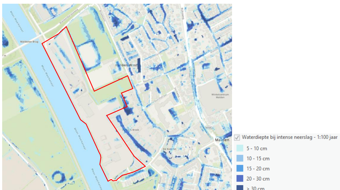
Figuur 2-23 Maximale waterdiepte bij extreme neerslag (bij neerslag 70 mm in twee uur). Het plangebied is indicatief aangegeven met een rood kader (bron: Klimaateffectatlas).
