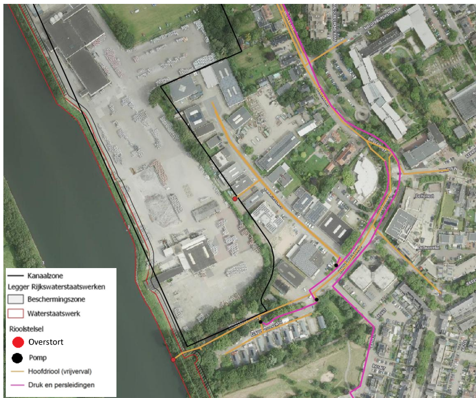
Figuur 2-22 Overzicht rioolstelsel
