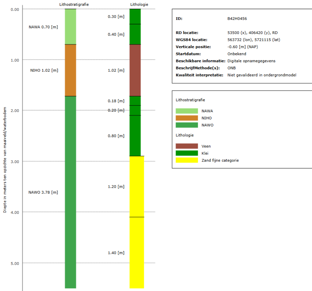
Figuur 5-5: Boorprofiel locatie 5.
