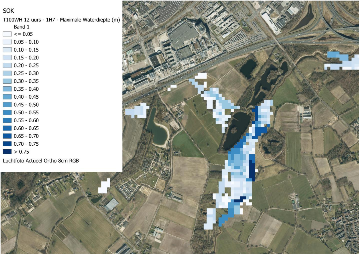
Figuur 5-5 In werking treden van de koppeling met een T100WH 12 uurs 1H7 – 700 L/s Run en +/- T1,5 op de Dommel
