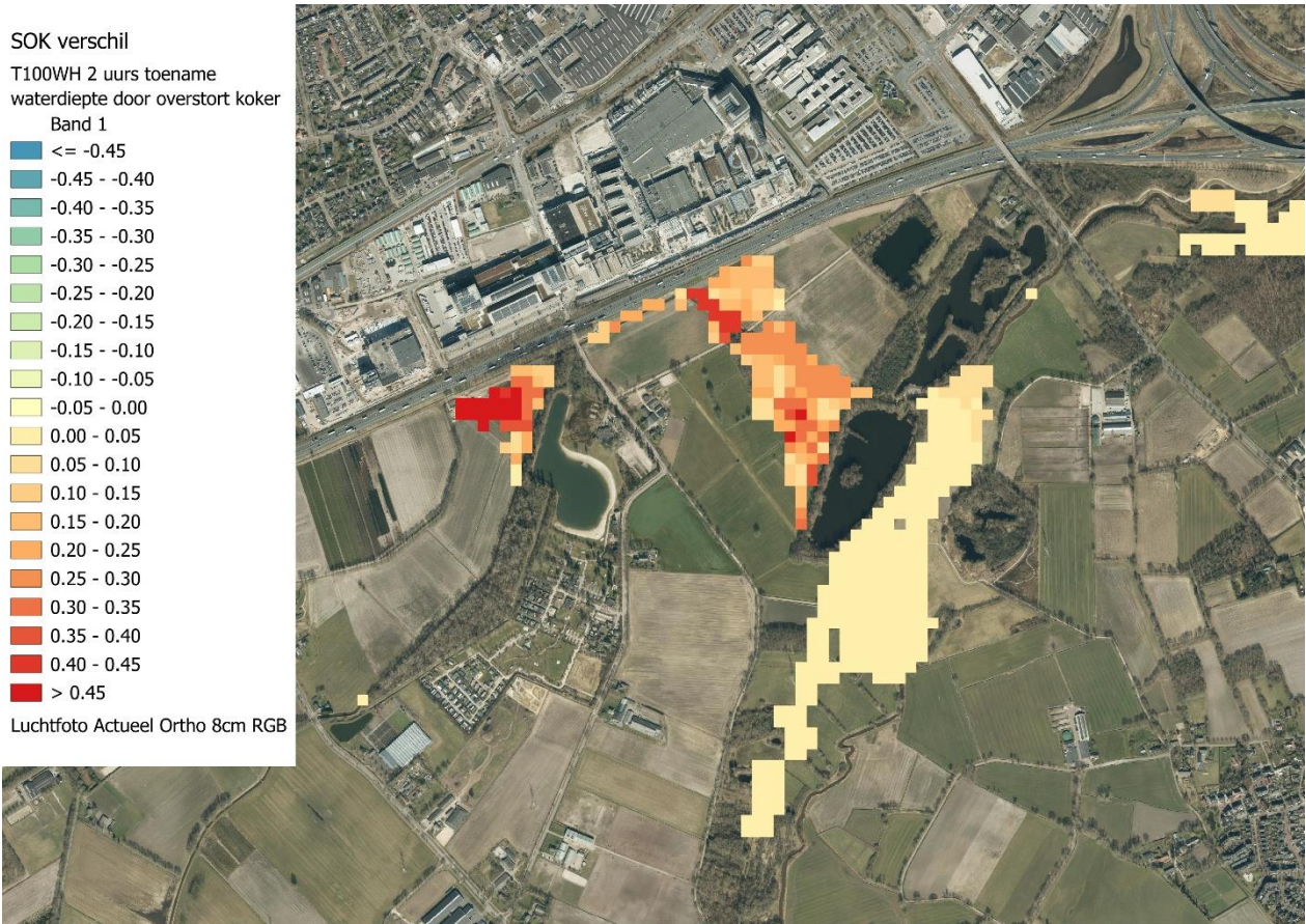
Figuur 5-8 Toename waterdieptes op maaiveld bij inwerking treden koppeling met een T100WH 2 uren bui 1H7 – 700 L/s Run en +/- T1,5 op de Dommel. Verschillen kleiner dan 2 centimeter zijn niet weergegeven.
