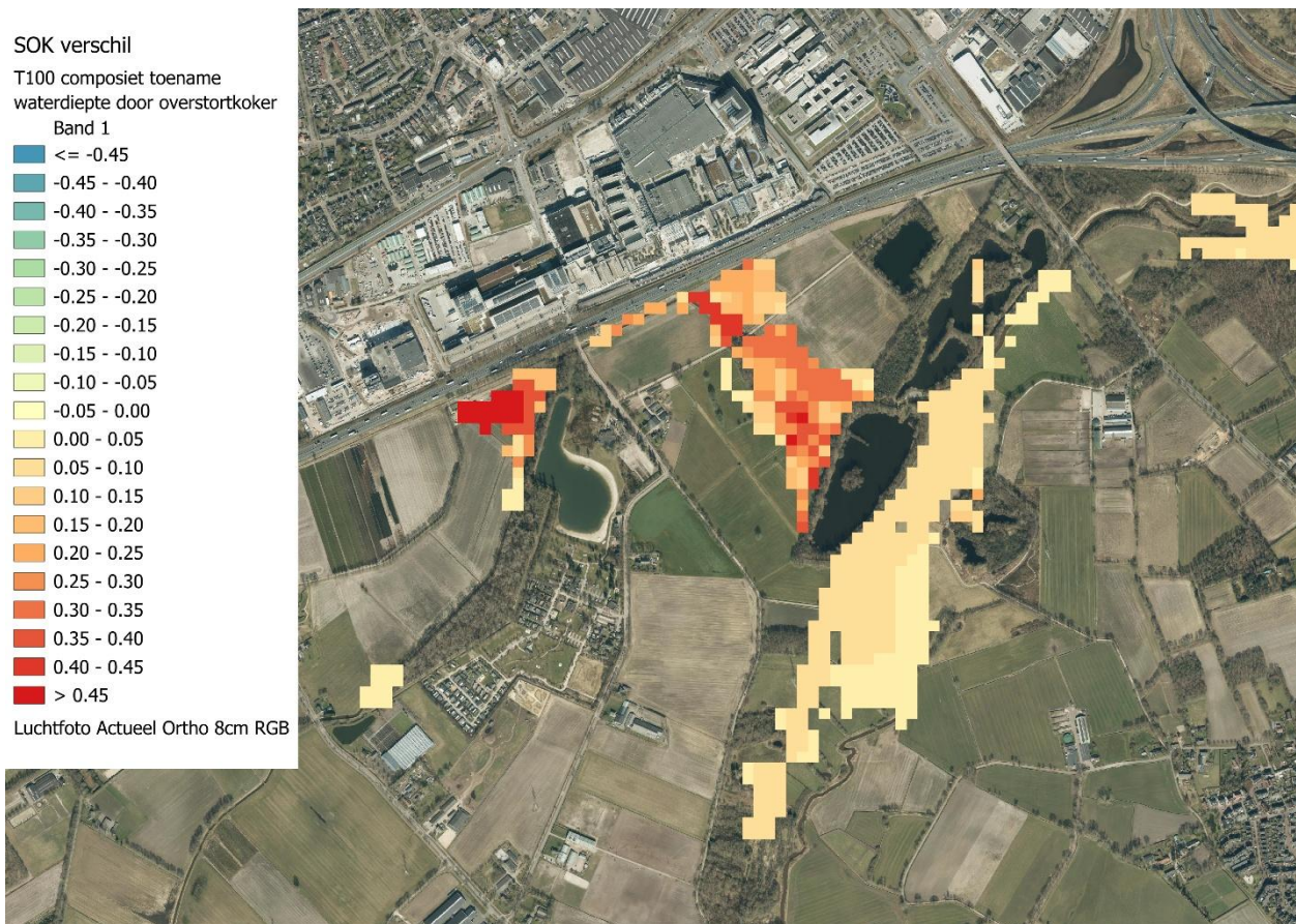
Figuur 5-4 Toename waterdieptes op maaiveld bij inwerking treden koppeling met een T100+20% Composiet 1H7 – 700 L/s Run en +/- T1,5 op de Dommel. Verschillen kleiner dan 2 centimeter zijn niet weergegeven.
