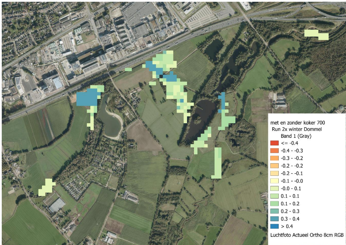
Figuur 4-16 Toename inundatie bij 700 l/s op de Run en 2x winterafvoer op de Dommel door de overstort van de koppeling
