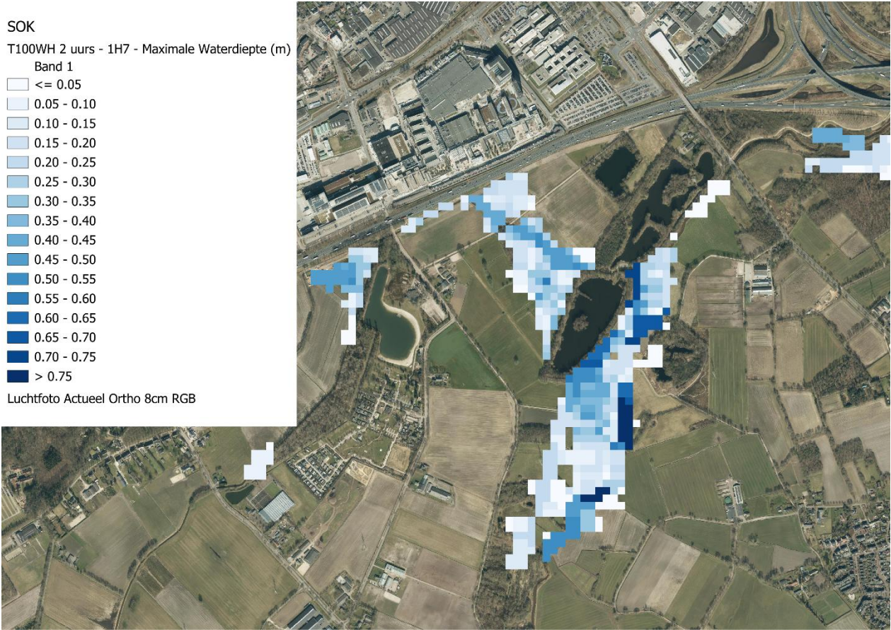
Figuur 5-7 In werking treden van de koppeling met een T100WH 2 uurs 1H7 – 700 L/s Run en +/- T1,5 op de Dommel
