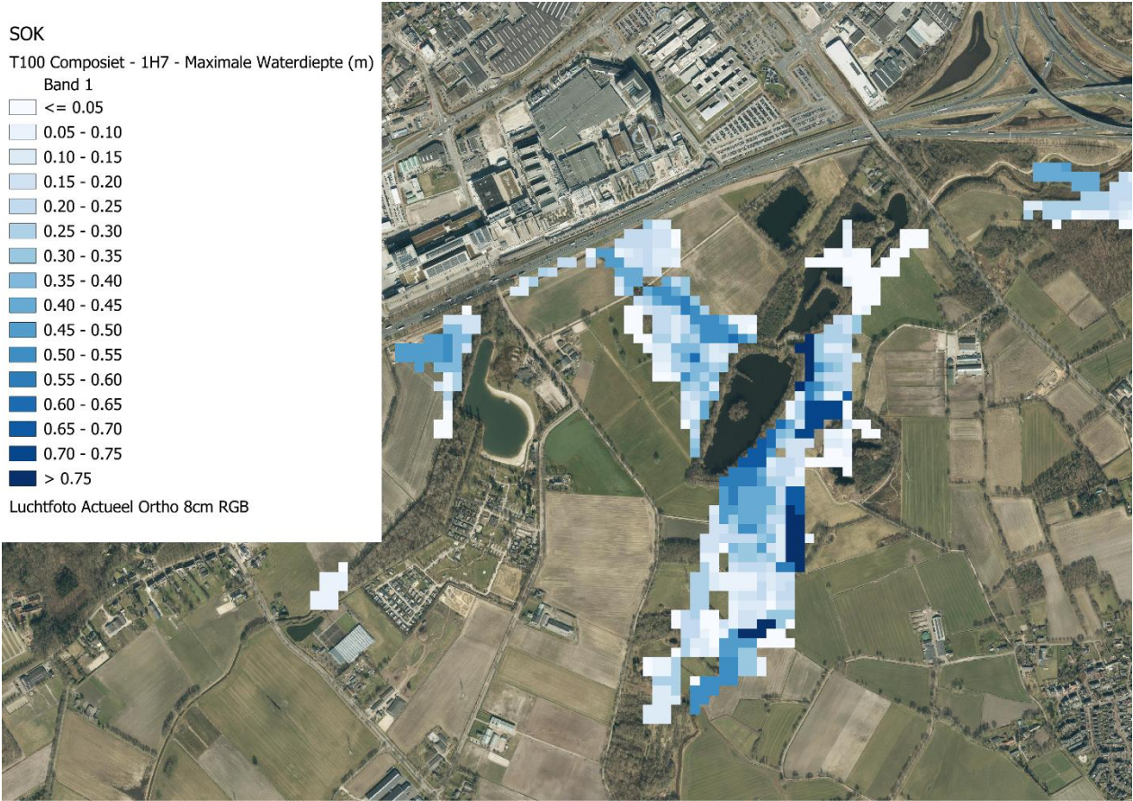
Figuur 5-3 In werking treden van de koppeling met een T100+20% Composiet 1H7 – 700 L/s Run en +/- T1,5 op de Dommel
