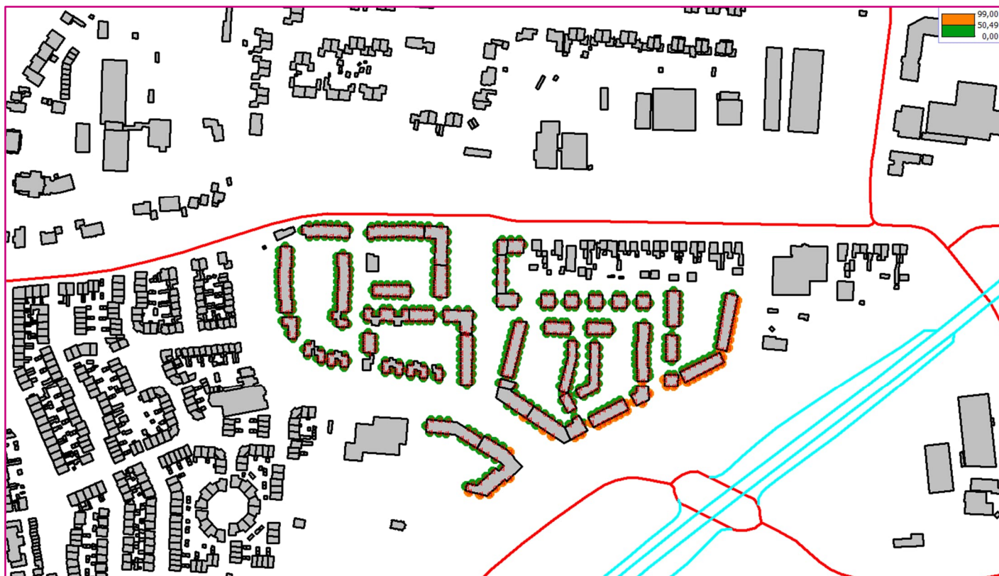
Afbeelding 7 : overzicht overschrijding standaardwaarde vanwege de N31
