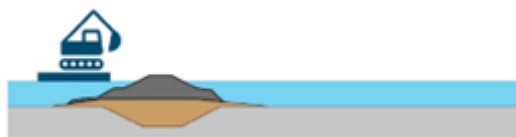
Stap 2: Het vrijgekomen holoceen materiaal kan gebruikt worden om het grondlichaam op te bouwen. Het materiaal moet rusten in een tijdelijk depot
