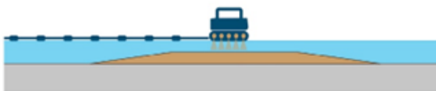
Stap 1: Aanbrengen basis zandlaag.
