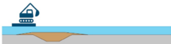
Stap 3: Het cunet wordt gevuld met zand
