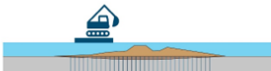
Stap 2: Aanbrengen van de drains.
