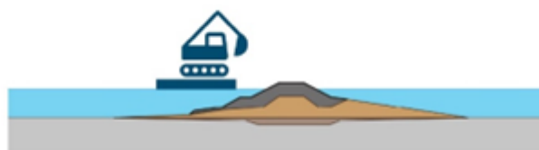
Stap 1c: In aantal ophoogslagen voorbelasting aanbrengen.
