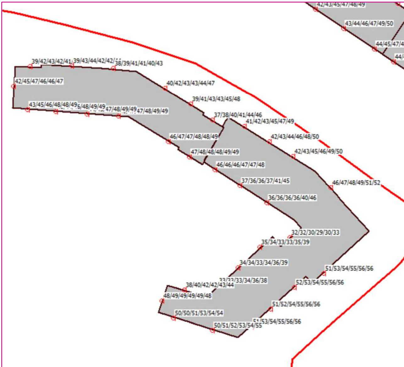
Afbeelding 10 : overzicht berekende geluidbelasting vanwege de N31, L_{den} in dB
