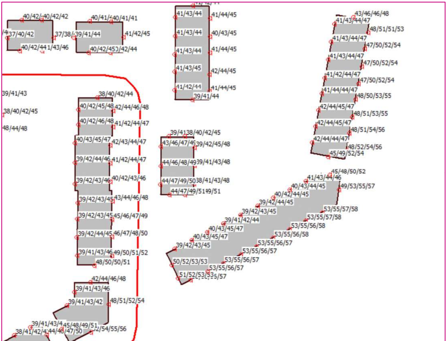
Afbeelding 8 : overzicht berekende geluidbelasting vanwege de N31, L_{den} in dB
