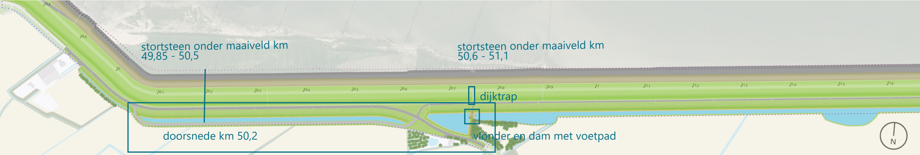
Nesserwei: bundelen watergangen; bundelen beheerpad en rijbaan; ecologische oever; toegang percelen
