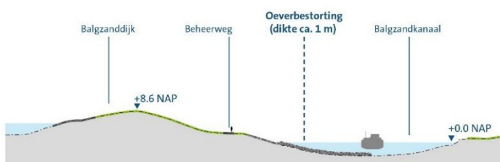
Figuur 3-6: Binnendijkse alternatieven Balgzandkanaal ter versterking stabiliteit (gele lijn in Error! Reference source not found. ).
