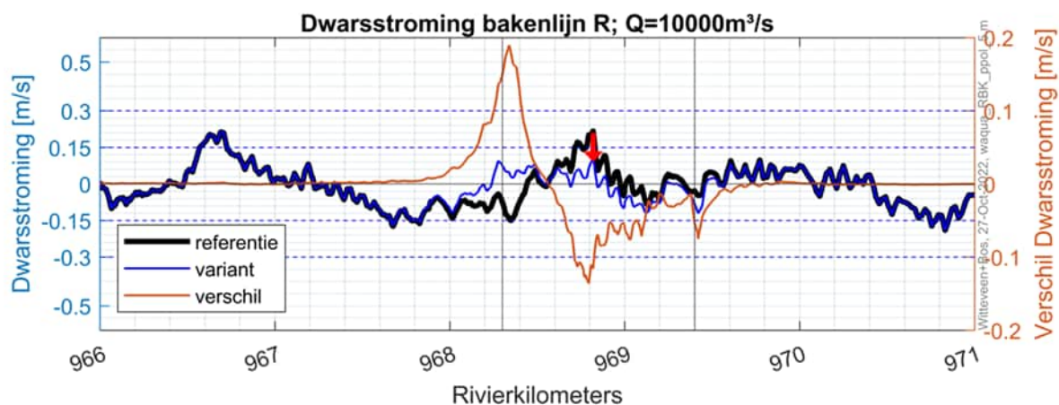
Afbeelding 9.5 Dwarsstroming in m/s op de rechteroever bij 10.000 m³/s. Positief richting uiterwaard, negatief richting vaargeul. Op linker y-as het resultaat voor de referentiesituatie en de variant, op rechter y-as het verschil tussen de variant en de referentie
