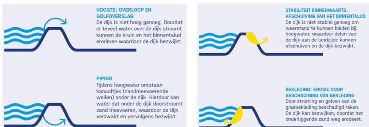
Afbeelding 2.1 Toelichting belangrijkste faalmechanismen voor IJsselwerken
