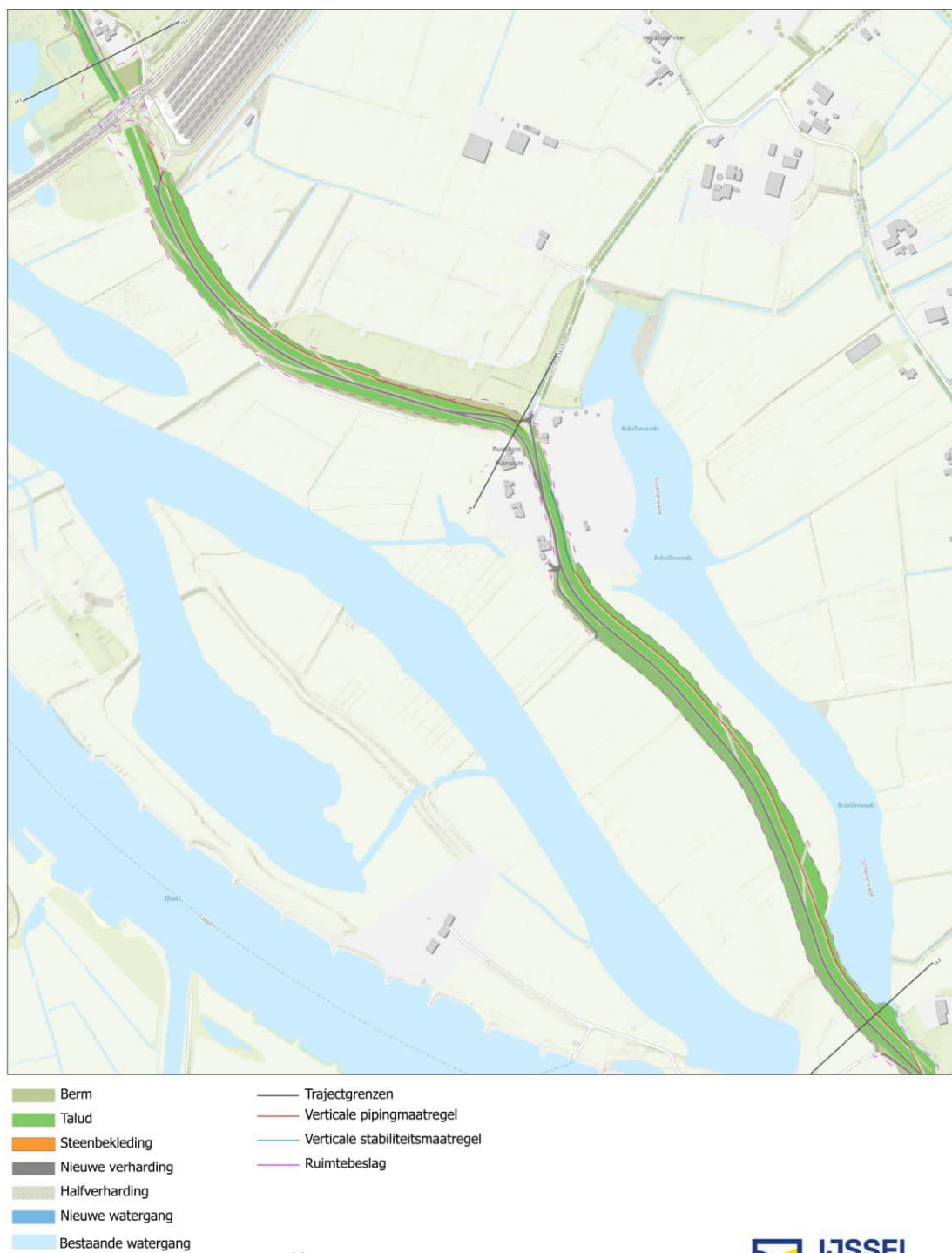
Afbeelding 5.37 Dijkversterkingsontwerp dijkmodule Noord 1
