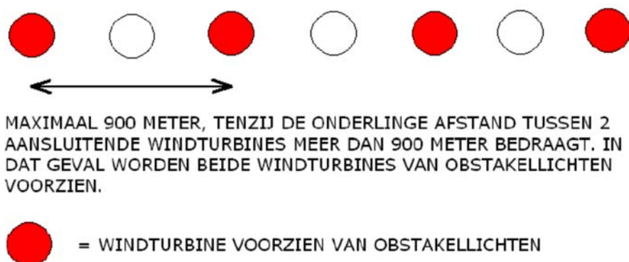
Figuur V – 2 Windturbines te voorzien van obstakellichten in een lijnopstelling
