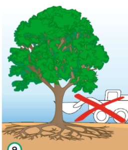
9 Rijd nooit met zwaar materieel over de wortelkluut. Dit leidt tot verdichting en verstikking van de bodem met wortelsterfte als gevolg. Is dit onvermijdelijk, plaats dan scheepshulden op een bed van grof zand.
