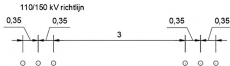
Figuur 3.1 Richtlijn kabelbed 110/150 kV in plat vlak, voor 2 circuits
